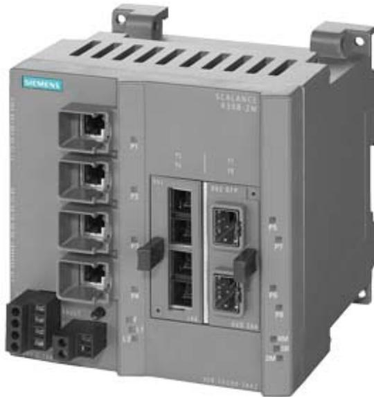
SCALANCE X308-2M; managed IE Switch, compacto; 4x 10/100/1000 Mb/s para puertos RJ45 eléctricos; 2 x 100/1000 Mb/s para módulos de medio de 2 puertos, eléctricos u ópticos; diagnóstico LED; contacto de señalización contacto; pulsador SELECT/SET; Dispositivo PROFINET IO; gestión gestión; administrador de redundancia integrado; Office características (RSTP, VLAN, IGMP,...); C-PLUG en el volumen de suministro
