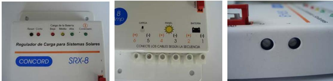
**Detalles de indicadores, bornera y calibración externa.**
